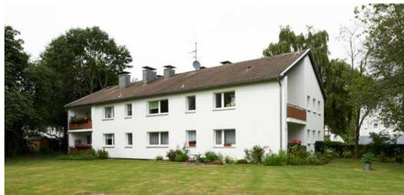
Die Gebäude wurden bereits im Laufe der Jahre saniert. 1990 wurden bei allen Häusern neue Kunststofffenster eingebaut und teilweise ein Wärmedämmverbundsystem auf die Fassaden aufgebracht. In den Jahren 2002, 2003 und 2009 wurden die Ölheizungen erneuert.
